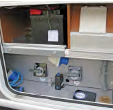
Alles vereint: Stromanschluss, Batterie, Wasser-Einfüllstutzen, Ablaufventile.
